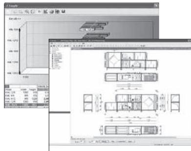
Подбор центральных кондиционеров осуществляется с помощью многоязыковой программы airCalc++, которая является отличным инструментом для инженеров по продажам, проектировщиков систем кондиционирования воздуха, так как осуществляет не только выбор типоразмера кондиционера и расчет функциональных блоков, но и выдает чертеж кондиционера (предусмотрено экспортирование в AutoCAD), его описание и диаграмму Мольте h-x.
